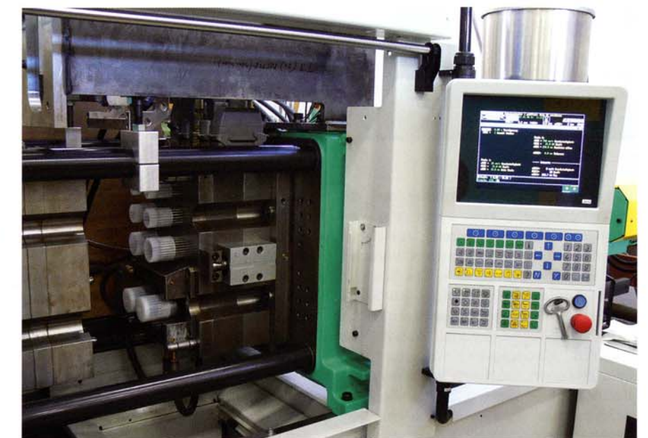
Hohe Produktivität: Am Ende eines Zyklus fährt das Handlingsystem in das geöffnete Werkzeug, entnimmt acht Bauteile und montiert sie oberhalb zu zwei Magazinen, während gleichzeitig acht neue Bauteile gespritzt werden. (Bilder: hej, Synventive)
